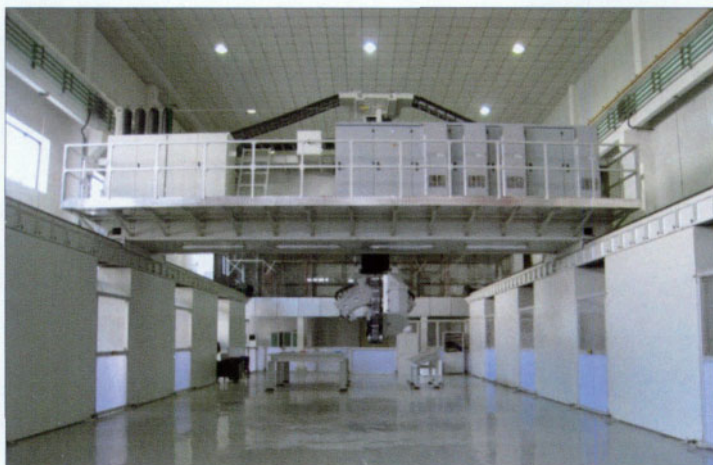
图1 北京航空制造工程研究所的大型多坐标自动铺带机
